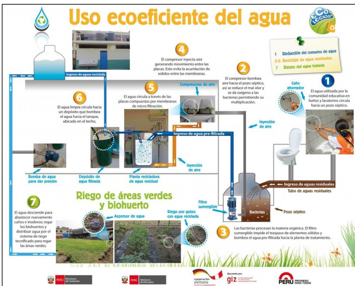
FIG Nº 39 - CICLO DE RECICLAJE DE AGUA (fuente: www.minam.gob.pe)
