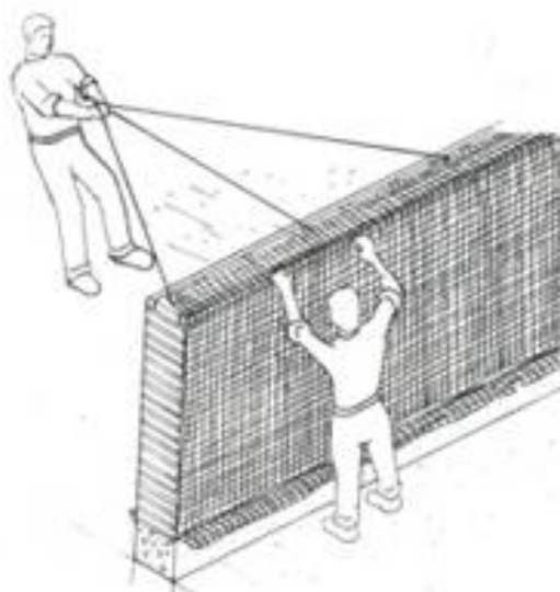
Colocación de geomallas.
