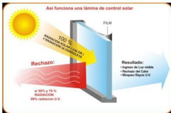
Las láminas de control solar rechazan, hasta el 90% de la radiación solar y el deslumbramiento y al mismo tiempo en épocas de frío puede impedir la pérdida de hasta el 20% de calor interior.
