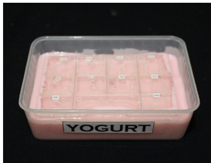
Figura 23. Piezas sumergidas en bebida seleccionada. Fuente: Propias de la investigación.
