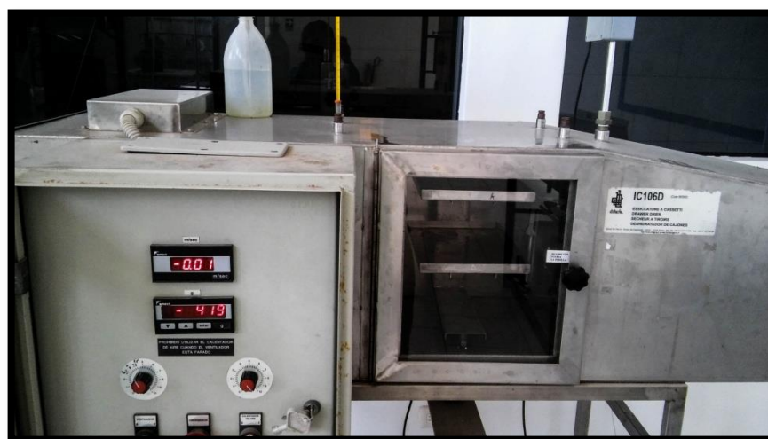
Figura 08. Máquina de secado semi-industrial a 40°C
