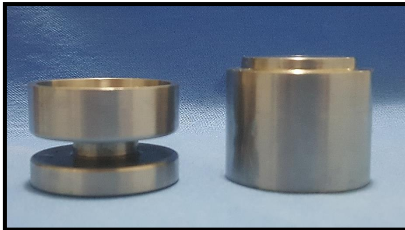
Fig. 5 Modelo maestro y Porta impresiones
