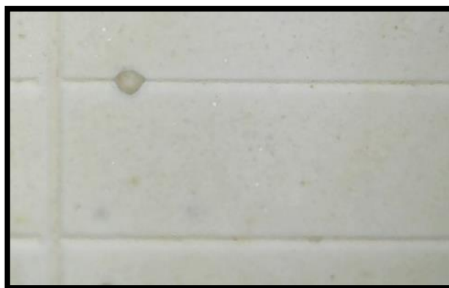
Fig. 39 Imagen obtenida del microscopio digital con la silicona de condensación II sin aplicación de adhesivo.
