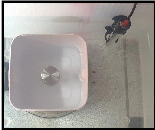
Fig. 30 Baño de agua mantenido a 35°C por un termostato.
