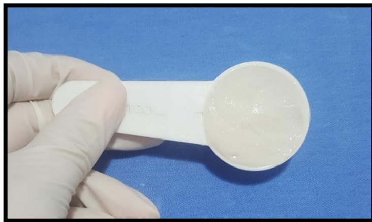
Fig. 16 Dosificación de la masilla
