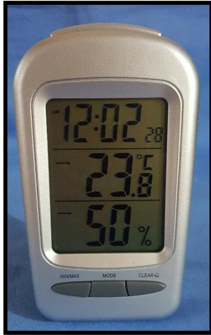
Fig. 35 Medidor de Temperatura y humedad
