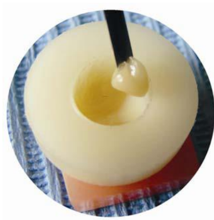
Figura N° 14: Colocación de la resina, usando el molde.
