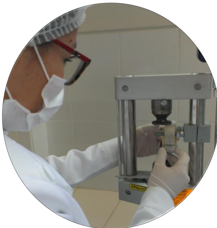
Figura n° 18: Ensayo de resistencia de fuerzas de cizallamiento.
