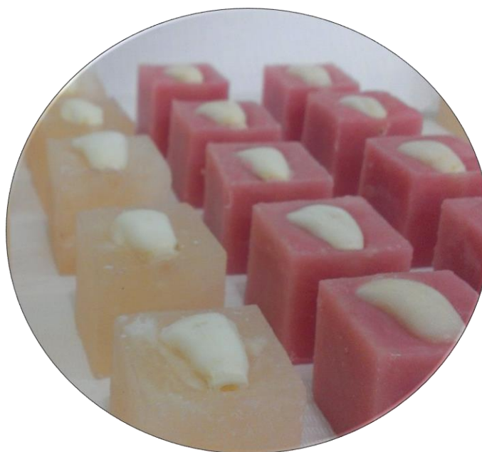
Figura N° 16: Bloque de acrílico con muestras para ensayo de resistencia
