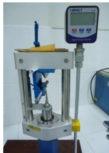
Figura N° 41: Muestra montada para ensayo con aplicador de fuerzas puntuales. (Fuente propia del autor).
