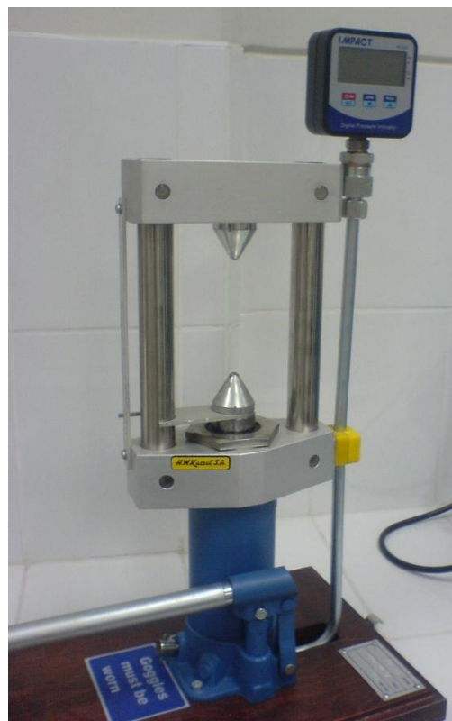
Figura N° 51: Máquina de ensayos “Aplicador de fuerzas puntuales” (Laboratorio de Suelos de la UPT).
