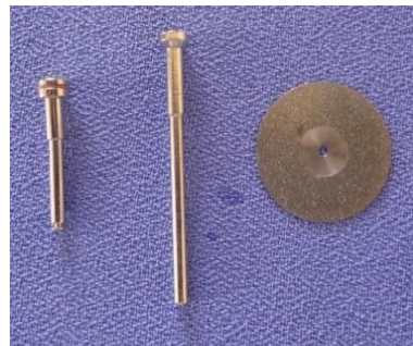
Figura N° 31: Disco de acero y mandril para micromotor. (Fuente propia del autor).
