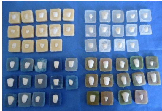
Figura N° 40: Bloque de acrílico con muestras para ensayo de resistencia de fuerzas de cizallamiento. (Fuente propia del autor).
