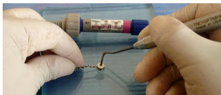
Fig. 05: Elaboración de cilindros de resina bajo la técnica incremental.
