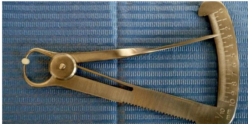
Fig. 07: Verificación del diámetro de cilindros de resina con ayuda de un calibrador para fresas.
