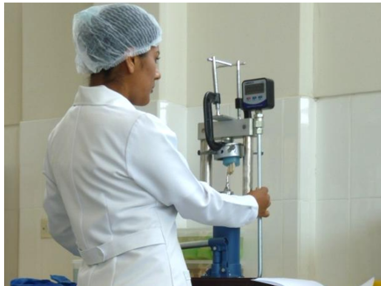
Fig. 16: Resultados tomados en Newton y registrados para su posterior conversión a MPa.
