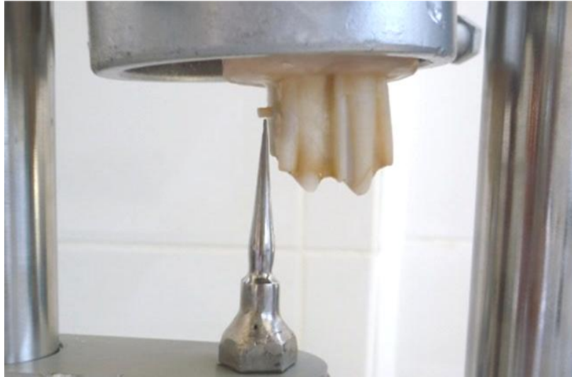
Fig. 15: Punzón calibrado, de modo que la tangente de aplicación de fuerzas se halle a 90^\circ , en relación al eje de la resina adherida.
