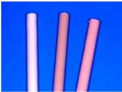
Fig. 16: Barras de gutapercha de diferentes colores de la casa "HYGENIG". Normalmente la gutapercha se encuentra en la forma BETA (punta de gutapercha para odontología, a temperatura ambiente)
