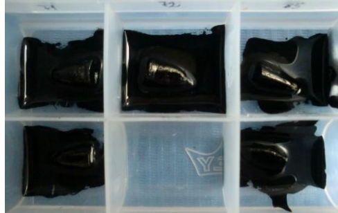
Sumergido en tinta china para la filtración
