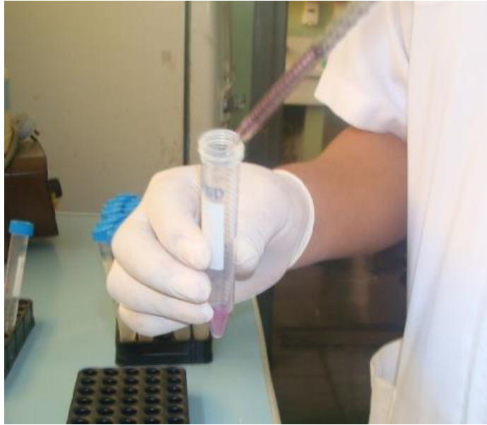
Figura 12: Se coloca 1ml del reactivo de trabajo sobre 20ul de la muestra y/o estándar.
