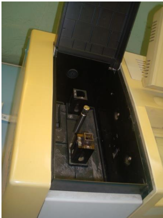
Figura 14: Se coloca la cubeta en el espectrofotómetro y se mide la absorbancia. Se repitió este procedimiento dos veces para hallar un valor promedio.
