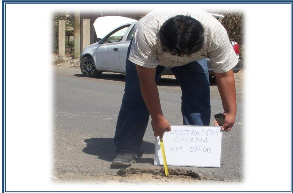
**FOTO N° 01:** Extracción de muestras en los diferentes tramos
