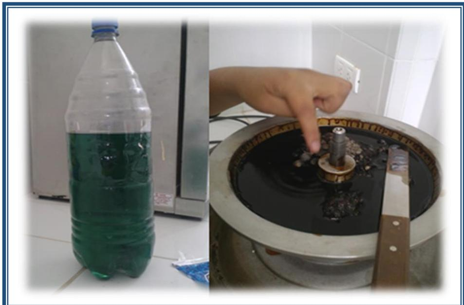
**FOTO N° 04:** La muestra seca se coloca en la centrifuga y se le agrega el disolvente
