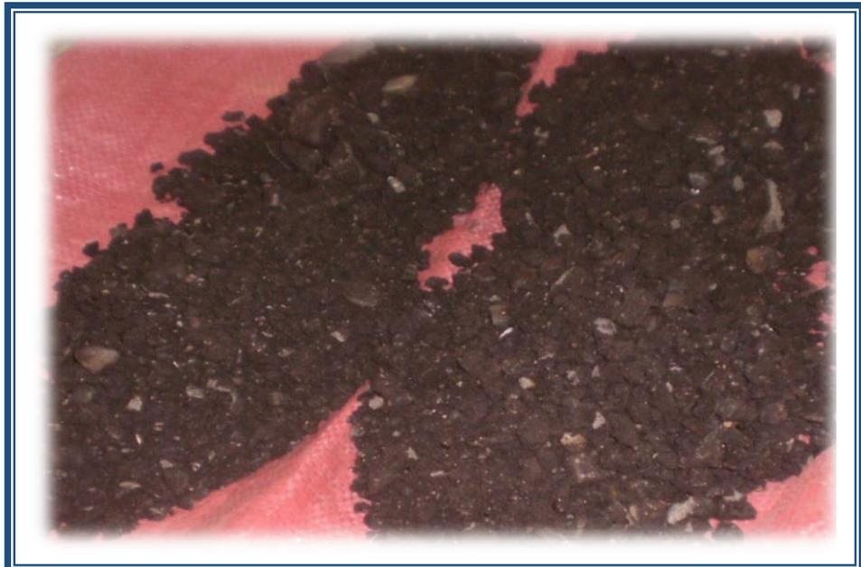
**FOTO N° 03:** Se realiza el cuarteo de la muestra para el ensayo
