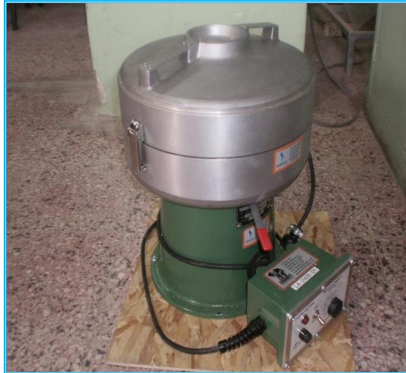
Extractor centrifugo con control análogo a prueba de explosión 1500g, son utilizados para determinar el contenido de asfalto ligante en muestras de mezcla en caliente y frio en muestras de pavimentos, a fin de comprobar el diseño por especificación, o para aceptación, evaluación de servicio, control e investigación.
