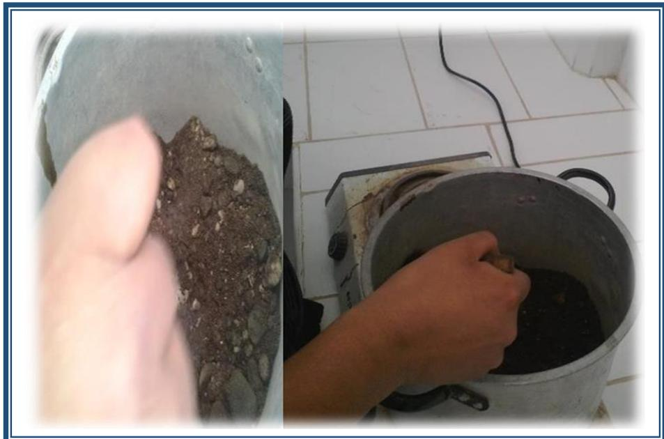
**FOTO N° 12:** Luego se procede a secar la muestra ya lavada y pesada
