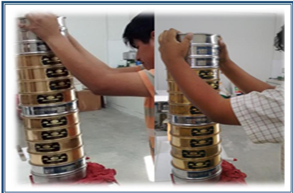
**FOTO N° 14:** Con las muestras totalmente secas se procede a tamizarlas para finalmente pesarlas
