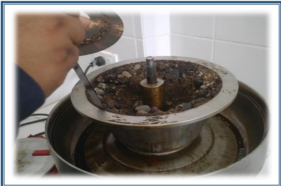
**FOTO N° 08:** Se le va agregando más liquido disolvente según sea el caso
