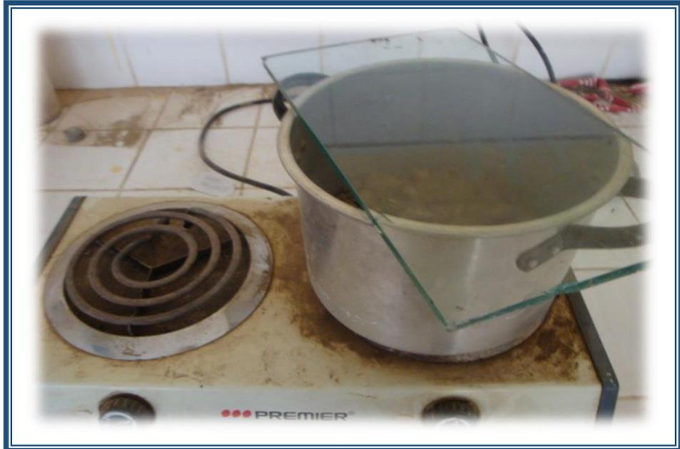
**FOTO N° 13:** Con la ayuda de un vidrio se verifica la presencia de humedad
