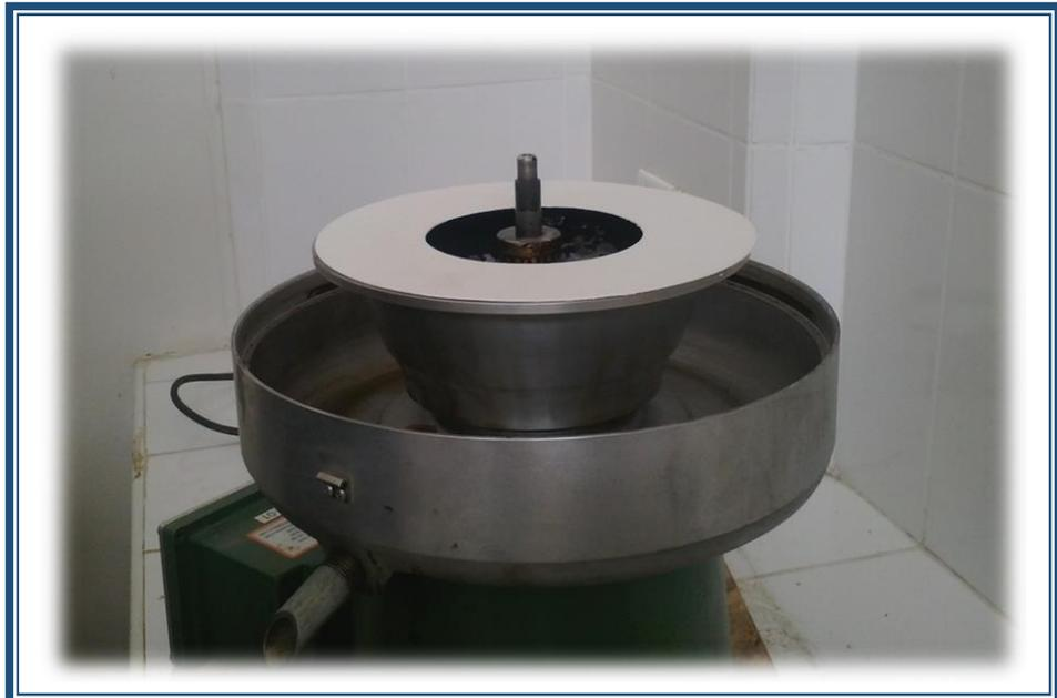
**FOTO N° 05:** Se coloca el filtro papel en el extractor centrífugo
