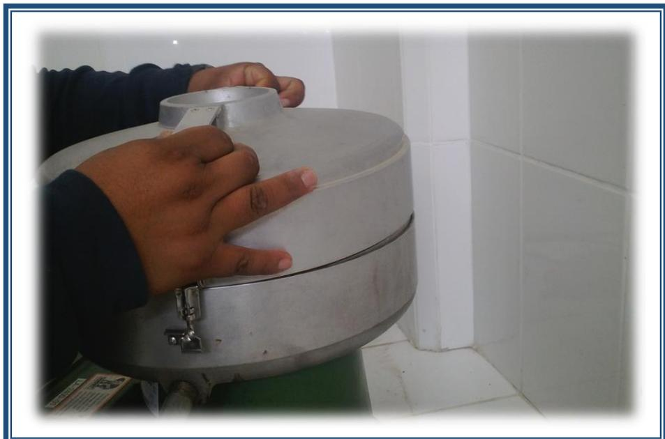
**FOTO N° 06:** Se coloca el plato metálico y se procede a asegurar la tapa exterior
