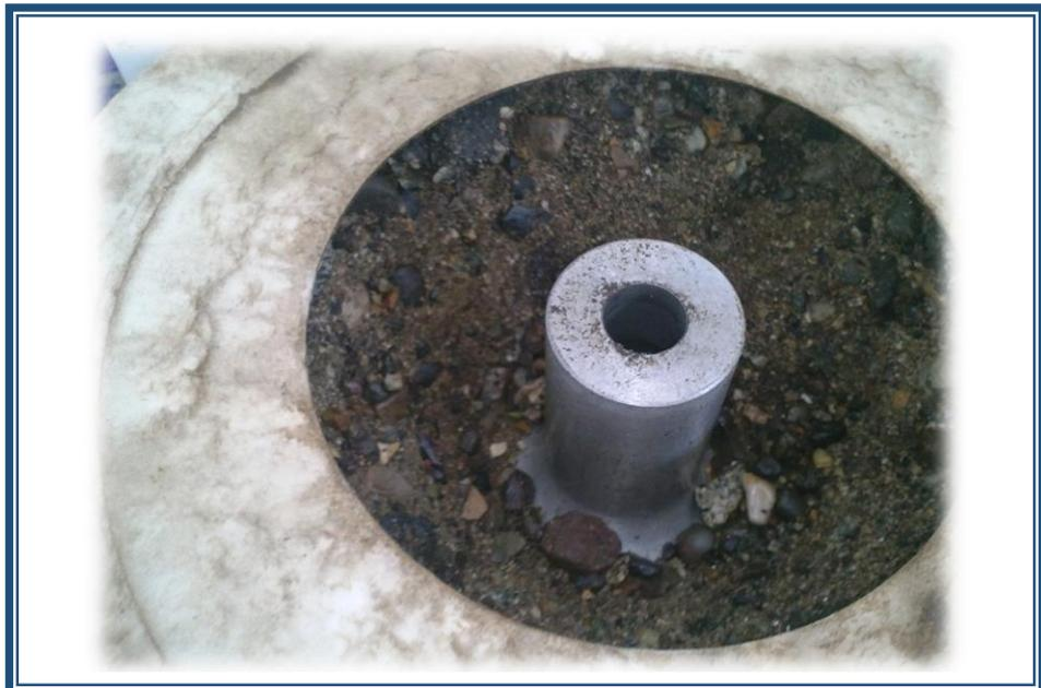
**FOTO N° 10:** La muestra tiene que quedar totalmente exento de asfalto o bitumen y habiéndose recogido el material adherido en el papel filtro
