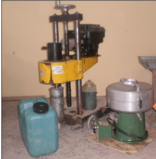
La fotografía muestra los equipos que se han utilizado en la evaluación de la carpeta asfáltica.
