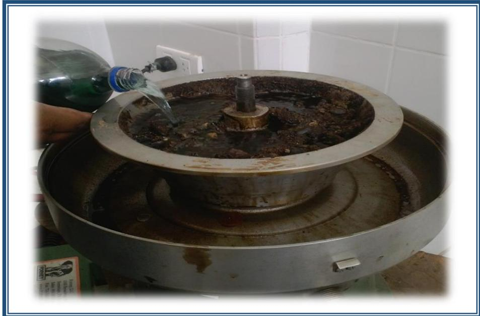
**FOTO N° 09:** Se le agrega el disolvente hasta que la muestra quede sin la presencia de asfalto
