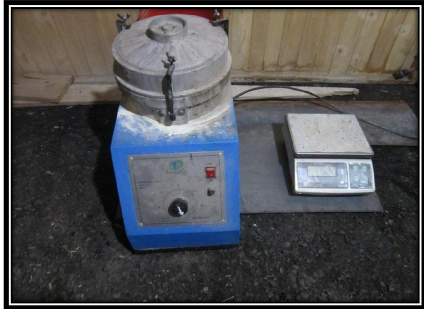
**Figura N°30: Centrifuga para Lavado Asfáltico**
