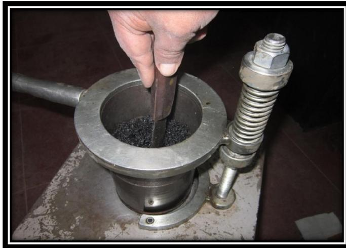
Figura N°27: Moldeo de testigos para ensayo Marshall
