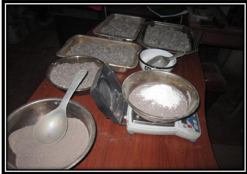
**Figura N°25: Pesado del material para ensayo Marshall**
