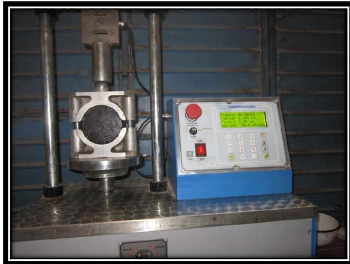
Figura N°28: Rotura de testigos en prensa Marshall
