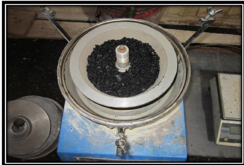
**Figura N°31: Lavado Asfáltico**
