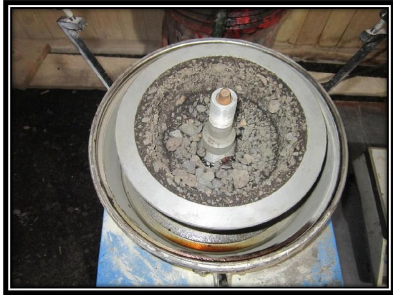
**Figura N°32: Lavado Asfáltico**
