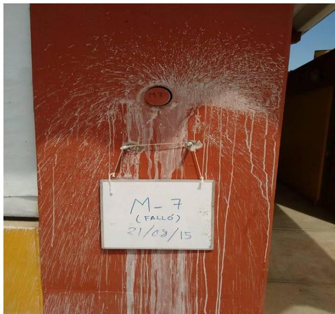
Vista de proceso de extracción de muestra M-7
