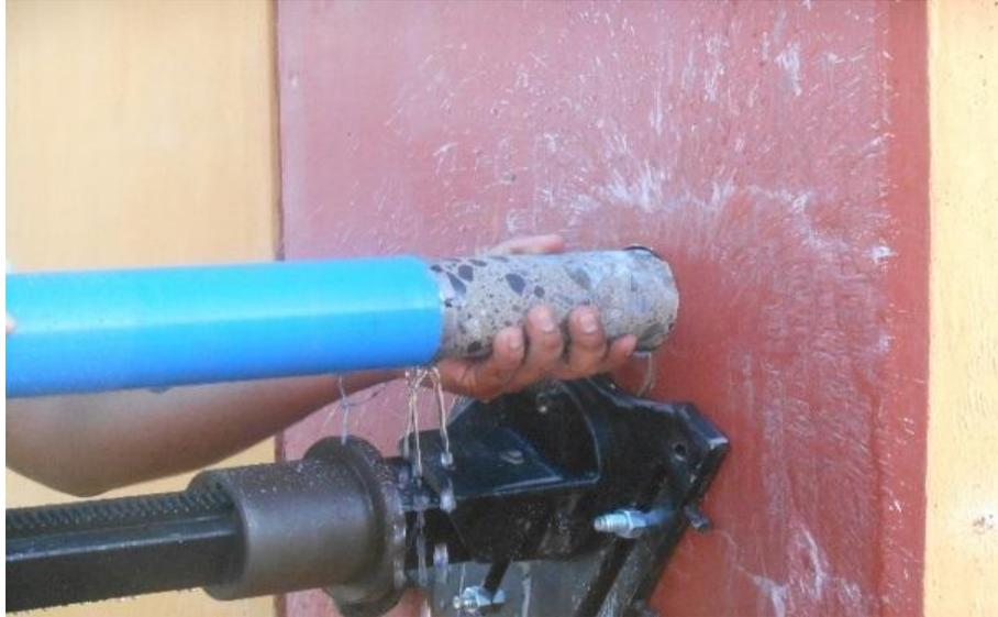
Vista de proceso de extracción de muestra
