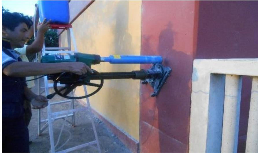
Vista de proceso de extracción de muestra
