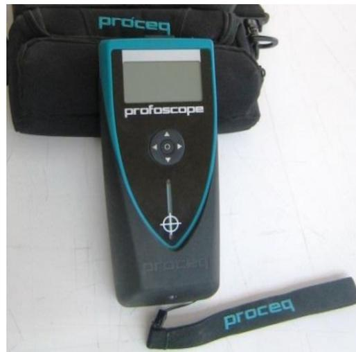
Las bobinas de la sonda se cargan periódicamente mediante impulsos de corriente, lo que genera un campo magnético. En la superficie de cualquier material conductor de corriente eléctrica dentro del campo magnético se producen corrientes de remolino. Dichas corrientes inducen un campo magnético en sentido opuesto. El cambio de tensión resultante puede utilizarse para la medición.
