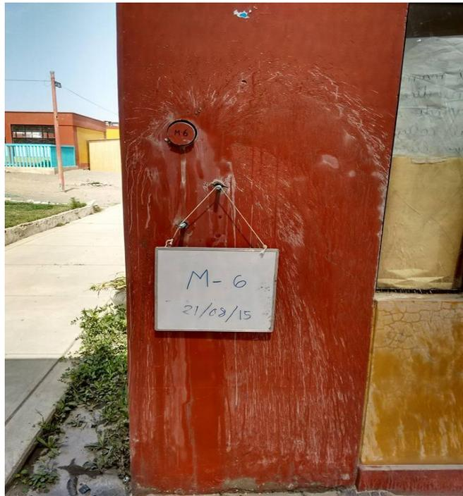
Vista de proceso de extracción de muestra M-6
