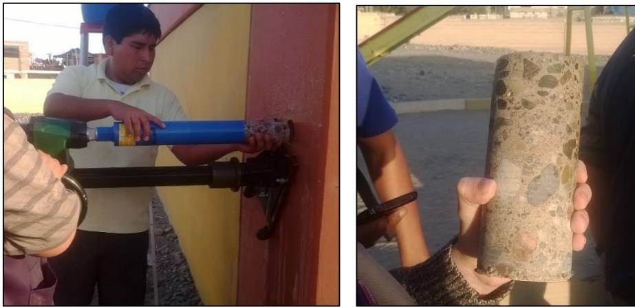
Figura 2.1. Extracción del núcleo de concreto con la Perforadora de Núcleos de diamantina.
