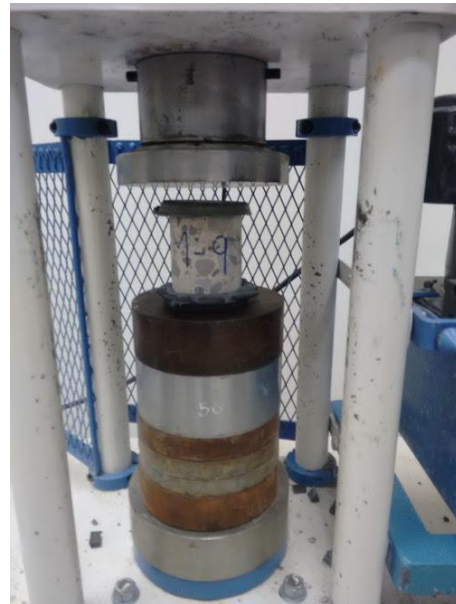
Ensayo de resistencia a la compresión en Muestra M9
