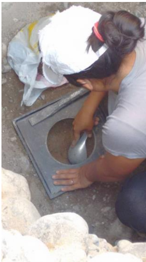
Realizando el ensayo de densidad INSITU (bolsa de agua)
