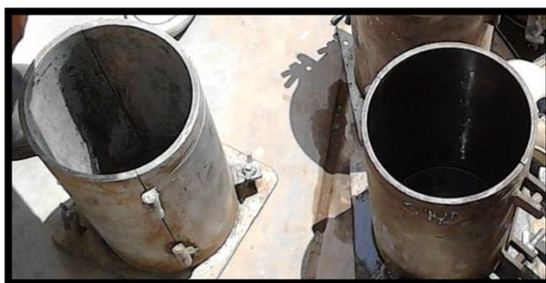
**FIGURA N°5.1** Moldes Cilindros para Probetas de concreto de 15 x 30 cm.
