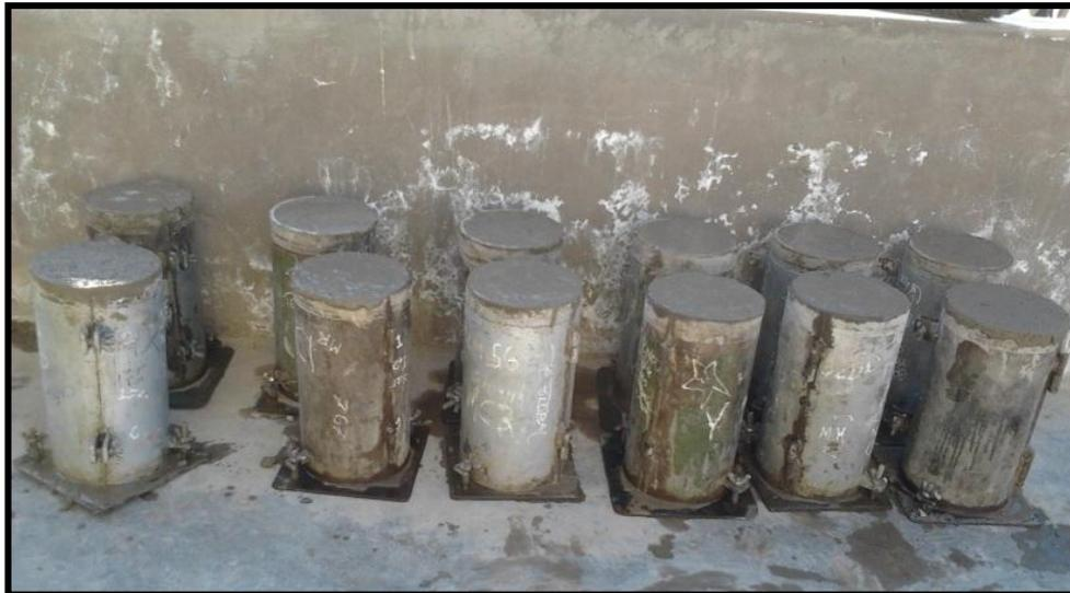
Fraguado del concreto, 24 horas para
