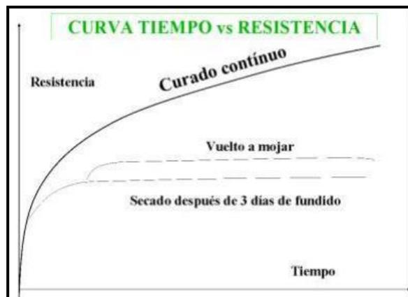
FIGURA Nº 5.2 Curva Tiempo vs Resistencia del Concreto.
