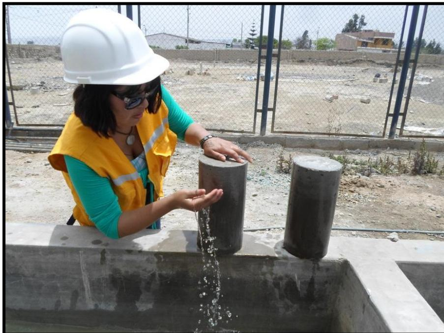
Secando las probetas de concreto para luego ser ensayados.
