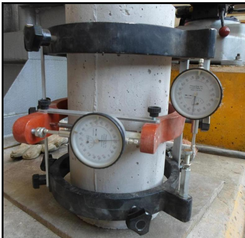
Equipo del compresómetro calibrado listo para ser colocado en la máquina de ensayo.
