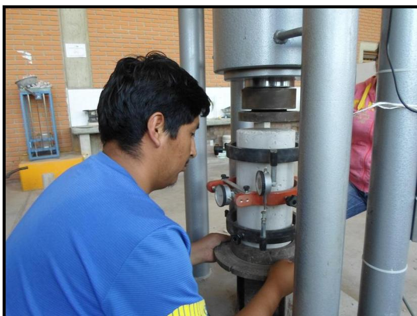
Ensayo de Compresión para la determinación del Módulo Estático de Elasticidad del Concreto en el equipo prensa de concreto.
