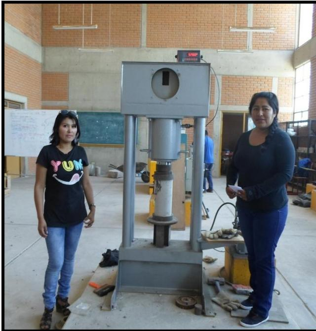
Realizando el ensayo a compresión para poder hallar su resistencia, para determinar el 40% de su resistencia máxima y así poder realizar el ensayo de módulo de elasticidad del concreto a la primera probeta.
