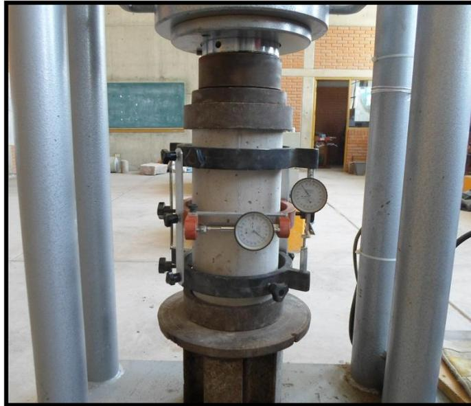
Ensayando las probetas de concreto a cargas del 40% de su resistencia.
