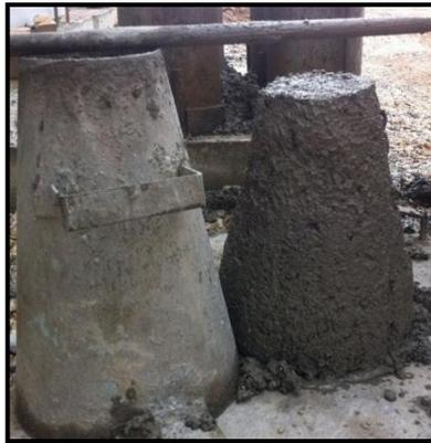
**FIGURA N°4.1** Medición del Asentamiento.
