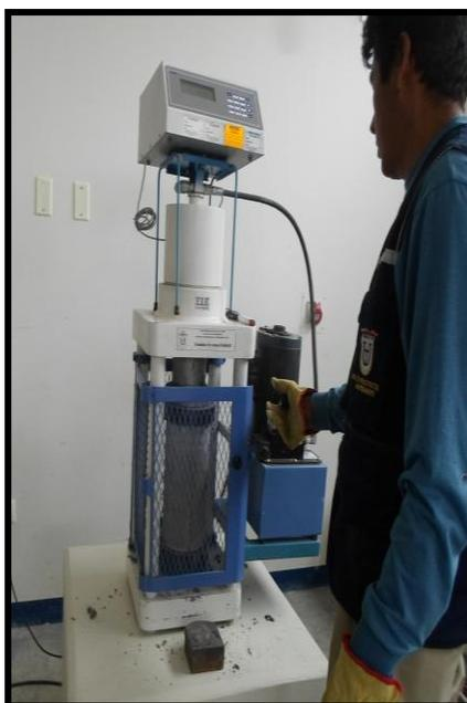
Las probetas de concreto colocadas en la máquina para realizar el ensayo a compresión para verificar su resistencia máxima.
