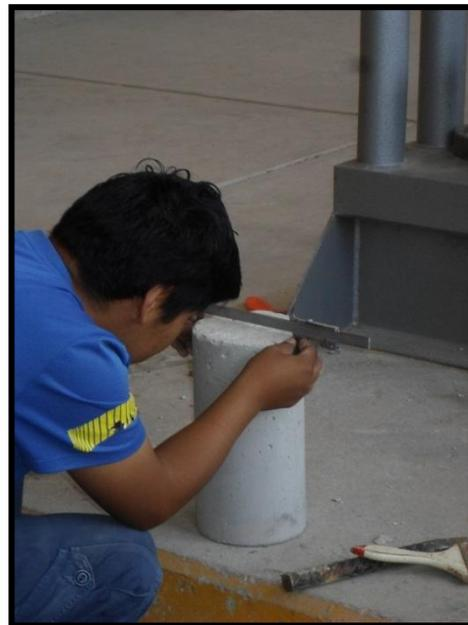
Probetas de ensayos, edad de curado 28 días.
