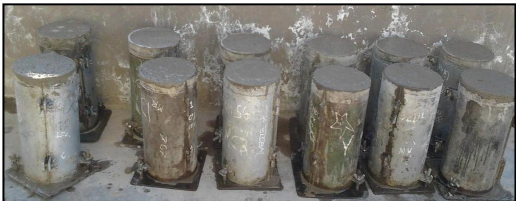
**FIGURA N° 4.2** Cilindros concreto Fresco.
