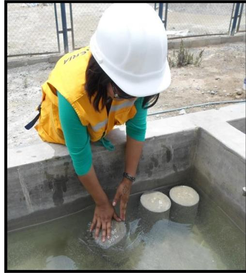
Sacando las probetas del pozo de curado para luego ser ensayadas.
