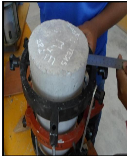
Colocación del compresómetro en la probeta para realizar el ensayo de módulo estático de elasticidad del concreto.
