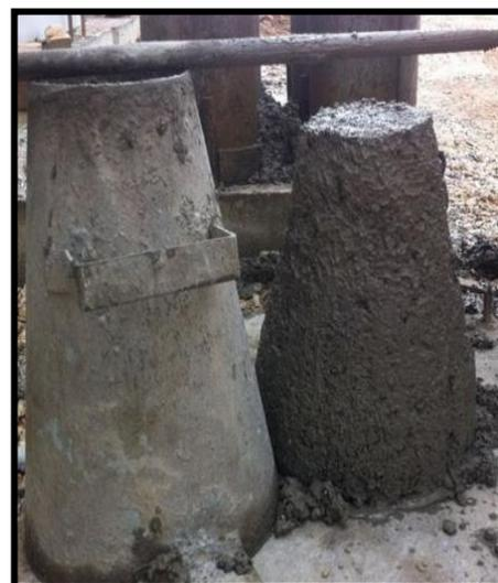
Determinación del asentamiento medido con el cono de Abrams para la mezcla definitiva.
