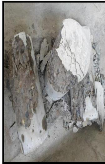
Fractura del probetas después de aplicada la carga de Compresión a un 100%.
