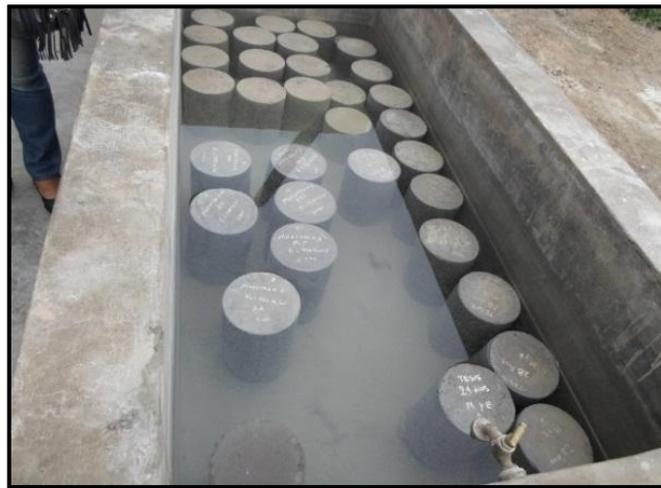
**FIGURA N° 5.3** Almacenamiento de Probetas en el Pozo de Humedad.
