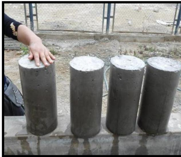
FIGURA Nº 2.3 Probetas de concreto para el ensayo a compresión.
