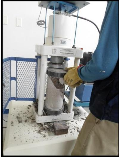
Ensayo a Compresión de las probetas de concreto hasta la Rotura.
