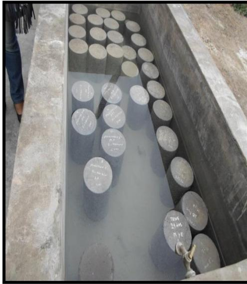
Pozo para el curado de las probetas.
