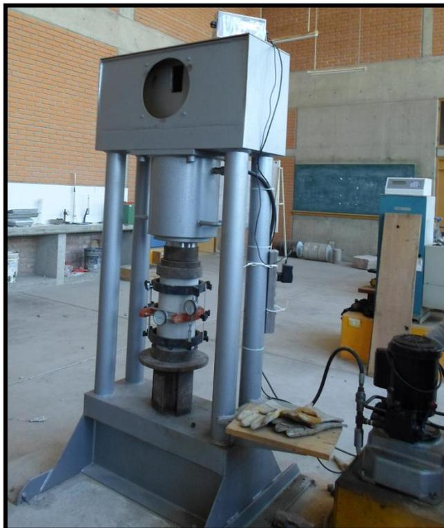
Aplicando cargas en el ensayo para determinar el Módulo Estático de Elasticidad del Concreto en el equipo prensa de concreto.
